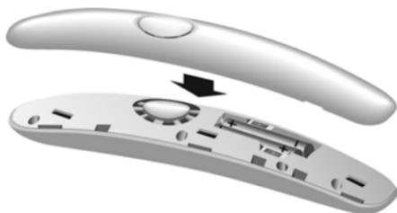
Ouvrir à nouveau le couvercle de batterie : ▶ Faire levier dans l'évidement et ôter le couvercle.
